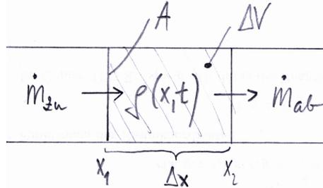
Im Folgenden werden wir die Massebilanz für das Kontrollvolumen  $\Delta V = A \Delta x$  (mit  $\Delta x = x_2 - x_1$ ) aufstellen.
