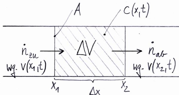
Im Folgenden wird die Teilchenbilanz für das Kontrollvolumen  $\Delta V = A \Delta x$  (mit  $\Delta x = x_2 - x_1$ ) aufgestellt. Während des infinitesimal kleinen Zeitintervalls  $dt$  wird durch die Grenzfläche  $A$  an der Stelle  $x_1$  die Teilchenzahl
