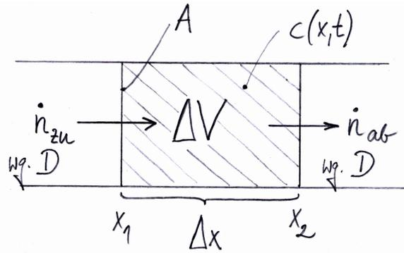
Gemäß der Skizze gibt es aufgrund der Diffusion mit dem Koeffizienten  $D$  an der Stelle  $x_1$  einen Teilchenzufluss  $\dot{n}_{zu} = \dot{n}(x_1)$  in das Volumenelement  $\Delta V$  und an der Stelle  $x_2 = x_1 + \Delta x$  einen Abfluss  $\dot{n}_{ab} = \dot{n}(x_2)$ .
