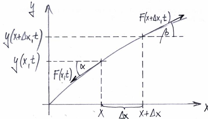
Die Auslenkung an der Stelle  $x$  zum Zeitpunkt  $t$  wird mit  $y = y(x, t)$  bezeichnet. An einem Saitenelement der Länge  $\Delta x$  mit der Masse
