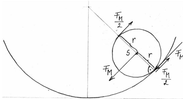
Die beiden zusätzlichen Kräfte  $\frac{F_M}{2}$  und die zusätzliche Kraft  $F_M$  (ausgehend von  $S$ , siehe Skizze 2) verändern weder das am Zylinder wirkende Drehmoment, da  $M = F_M r = \frac{F_M}{2} r + \frac{F_M}{2} r$ , noch die Bewegung des Schwerpunktes  $S$  selbst, da  $-F_M + \frac{F_M}{2} + \frac{F_M}{2} = 0$  gilt. Es wird jedoch sichtbar, dass im Schwerpunkt  $S$  die Kraft  $-F_M$  angreift.
